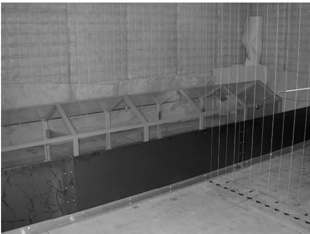
図1 半無響室における1/10縮尺模型による測定
